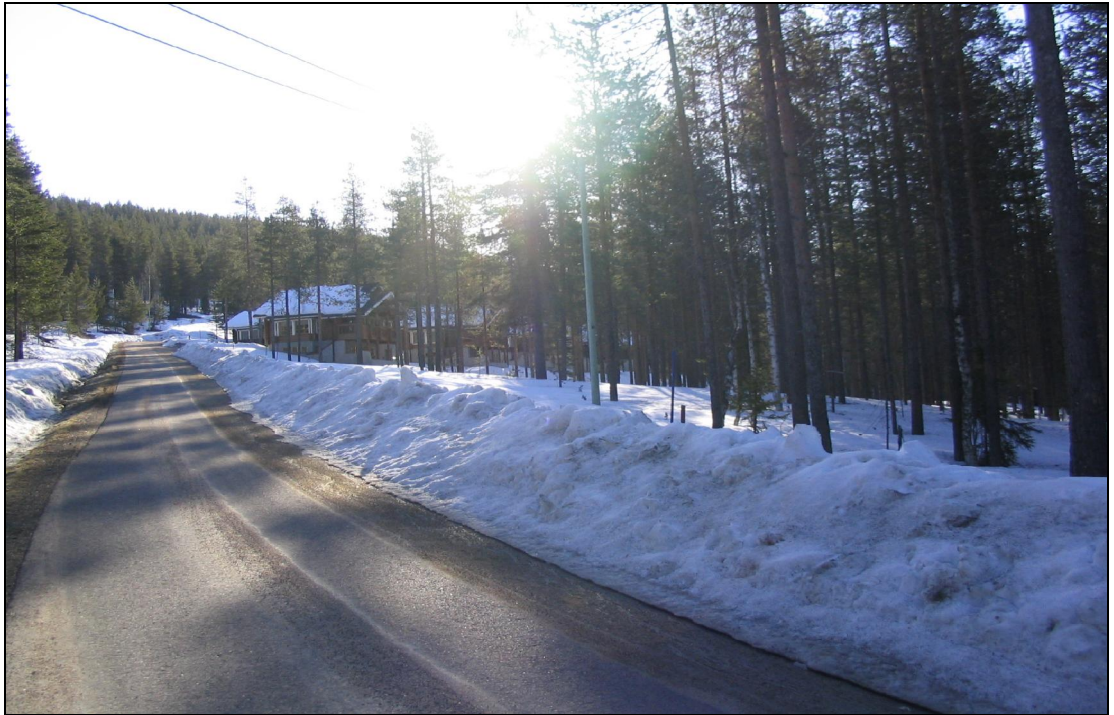
Kuva 2. Lumipenkat vaimentavat liikenteen melua (kuva Tuomo Kauppinen).
